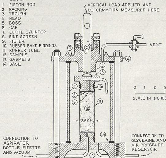
FIGURE 11.—THE TRIAXIAL COMPRESSION CHAMBER.
