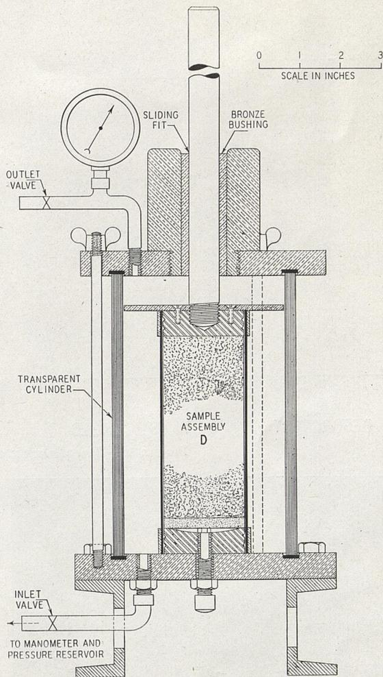
FIGURE 10.—STABILOMETER OF THE PLUNGER TYPE.
