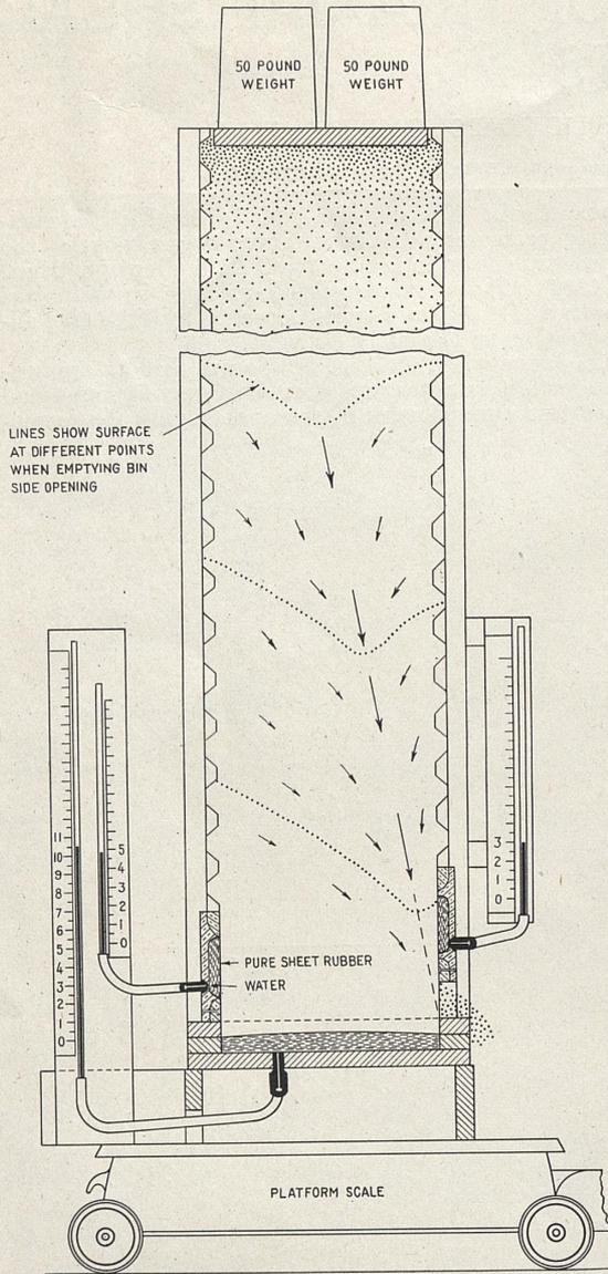
FIGURE 2.—MANOMETER USED BY JAMIESON.
